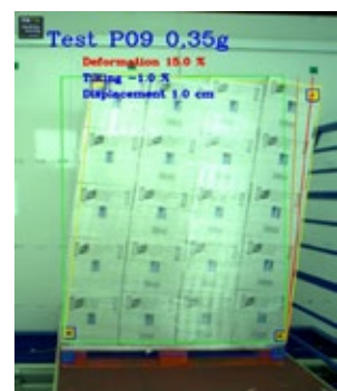
Deformación final P9 a 0,35g
